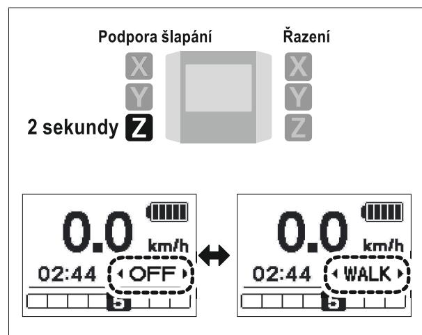
Pokud se zobrazuje "WALK", přidržte stisknuté tlačítko Podpora šlapání-Z spínače režimů pro zahájení podpory při chůzi. Po uvolnění tlačítka Podpora šlapání-Z podpora při chůzi ustane, nebo ji můžete přerušit stiskem tlačítka Podpora šlapání-Y.
