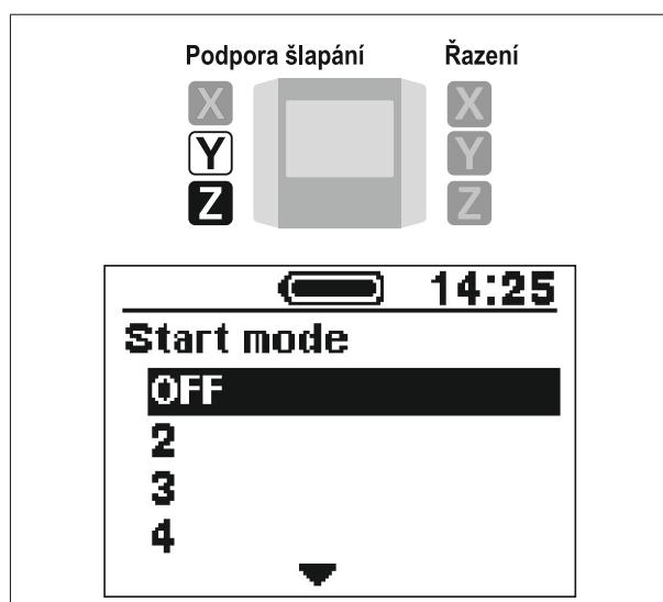
2. Stiskem Podpora šlapání-X potvrďte zvolené nastavení na pozici kurzu a přejdete zpět do zobrazení nabídky nastavování.
