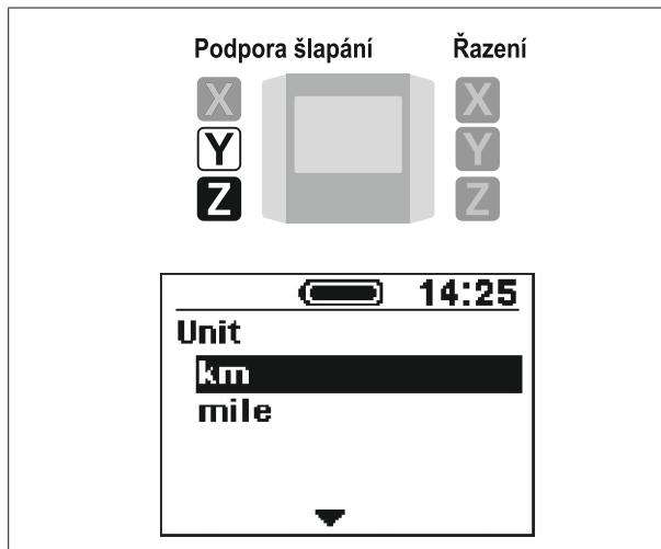
2. Stiskem Podpora šlapání-X potvrďte zvolené nastavení na pozici kurzoru a přejdete zpět do zobrazení nabídky nastavování.
