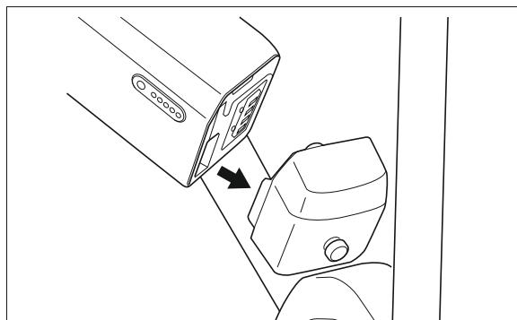
2. Z místa nasazení na výstupek posunujte aku-baterii vpravo. Aku-baterii zasuňte až do zaklapnutí.
