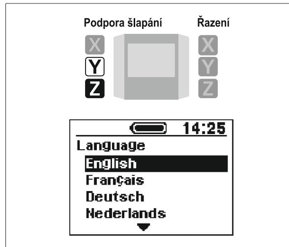
2. Stiskem Podpora šlapání-X potvrďte zvolené nastavení na pozici kurzoru a přejdete zpět do zobrazení nabídky nastavování.
