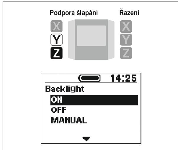
2. Stiskem Podpora šlapání-X potvrďte zvolené nastavení na pozici kurzu a přejdete zpět do zobrazení nabídky nastavování.
